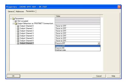
Fig. 7-11 Module parameters of the output module EX245-DY1-X37
